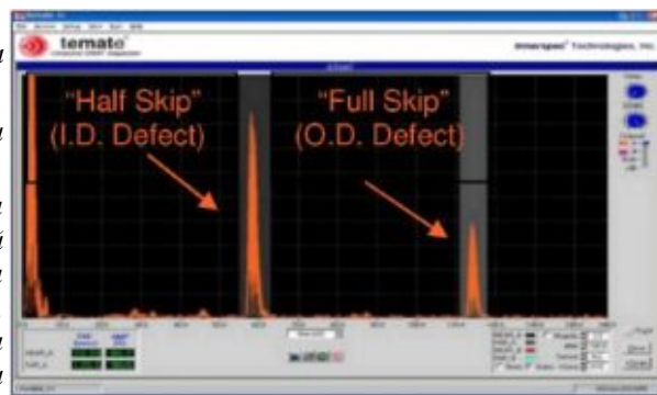
Рис. 7: A-scan Половина шага /Полный шаг
