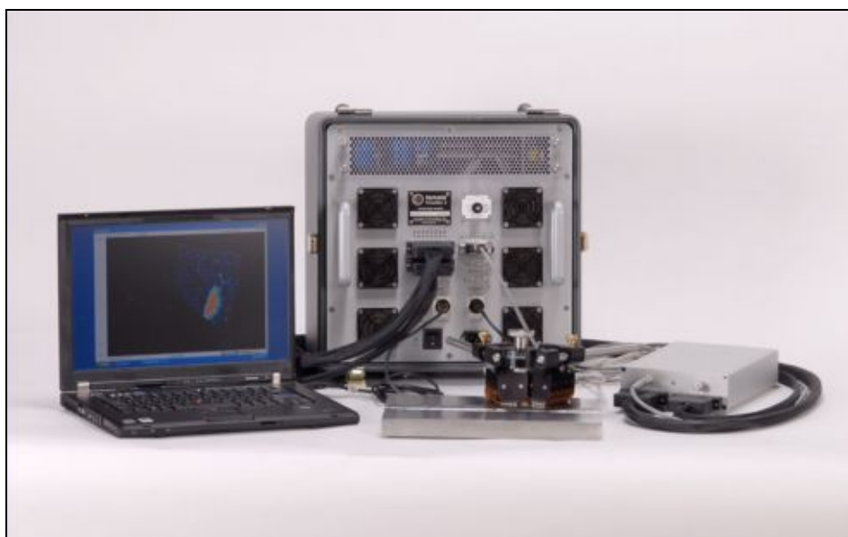
Рис 4: Основные компоненты системы для контроля с применением ЭМАП
