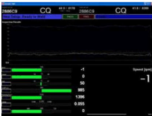
Рис. 5. Контроль с помощью интегрированного пакета контроля процесса сварки.
