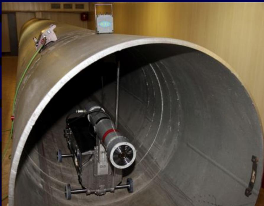
Рентгеновское изображение формируется при помощи панорамного источника рентгеновского излучения постоянного потенциала, расположенного внутри трубы и сканирующей тележки GW-4, которая перемещается вдоль шва на внешней поверхности трубы, принимает рентгеновское излучения, формирует и обрабатывает изображение сварного шва.
