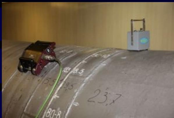
GW-4™ - автоматизированный цифровой сканер для рентгеновского контроля кольцевых стыков трубопроводов и резервуаров. Сканер на магнитных колесах позволяет контролировать трубы диаметром от 6" и больше.
