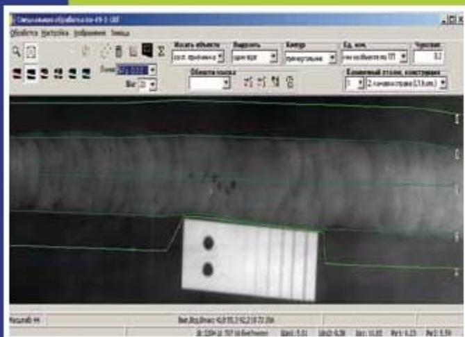
Обработка эталона чувствительности для вычисления оценки размера дефекта в направлении просвечивания (глубины дефекта)
