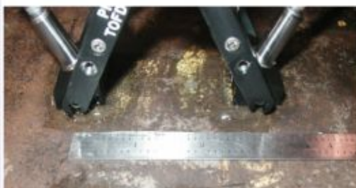
Датчики TOFD на эталонном образце
